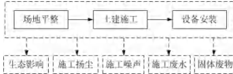
图 4-1 变电站建设期产污环节
